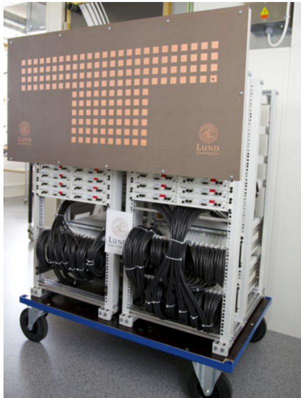
Figura 3.5. Prototipo LuMaMi en arreglo rectangular escalable de 128/160 antenas
