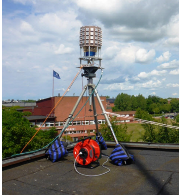
Figura 3.4. Prototipo en arreglo circular de 128 antenas sobre la Universidad de Lund
