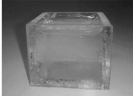
Figura 5.5: *Phantom* de la materia gris utilizado en experimentación.
