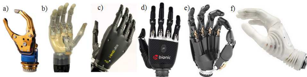
Figura 2.1. Prótesis de mano de izquierda a derecha: a) Sensor Hand Speed, b) iLimb, c) iLimb Ultra, d) Bebionic, e) Bebionic 3 y f) Michelangelo.
