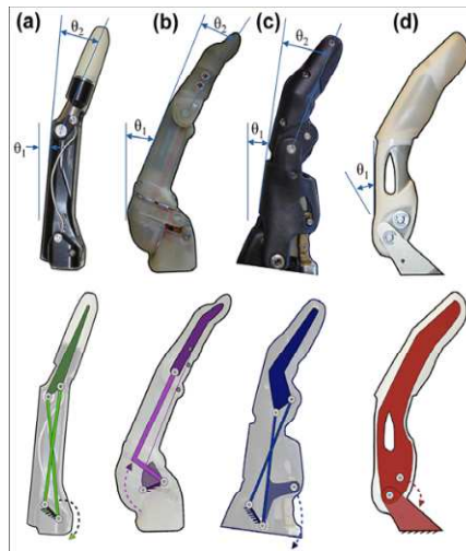
Figura 2.2. Dedos de prótesis comerciales y estructura cinemática del mecanismo de acoplamiento de las articulaciones de los dedos [31] a) Vincent, b) iLimb, c) Bebionic y d) Michelangelo.
