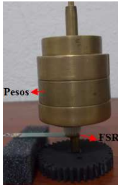
Figura 3.24. Montaje experimental para caracterizar el sensor de fuerza FSR.
