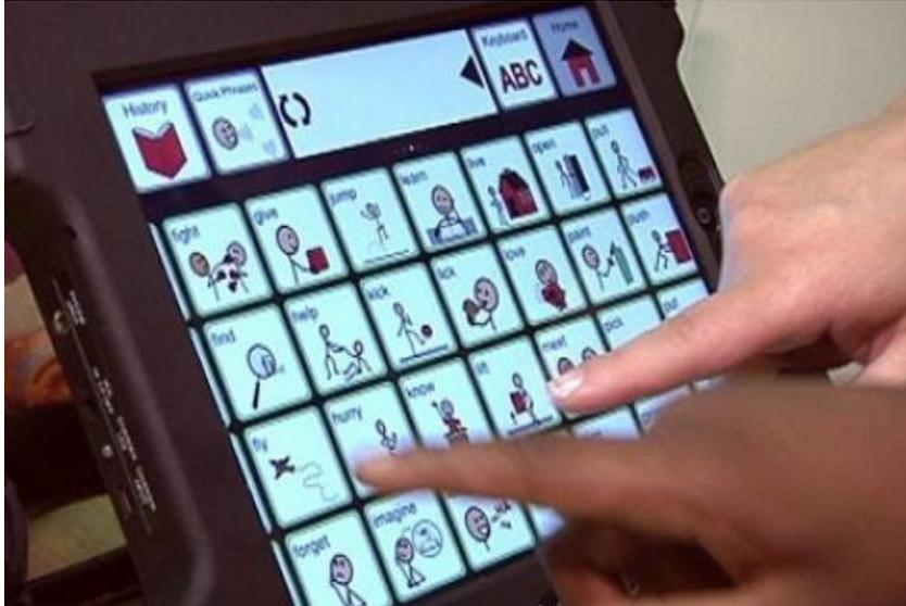
Figura 33. Ejemplo de comunicador electrónico utilizando PECS
